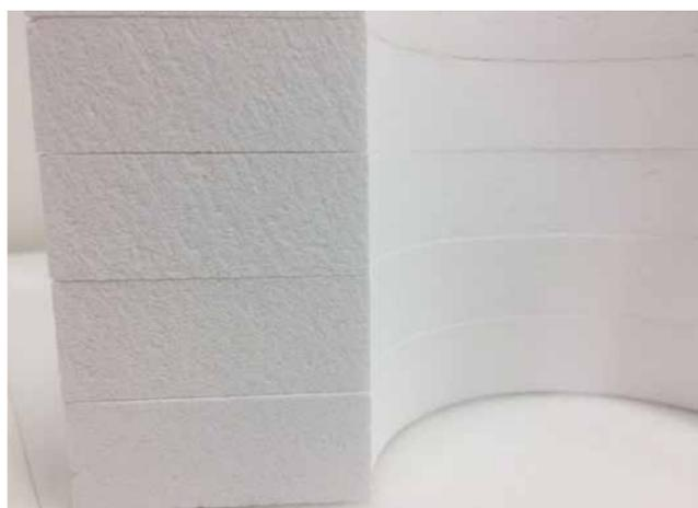
Bei Öfen, ab beispielsweise 16 Litern und je nach Anwendung, erfolgt die Auskleidung bei SCHUPP® Ceramics nach dem sogenannten **stack-bond** Verfahren. Dazu werden kleinere Streifen einfach aufeinander gelegt, um die Rissbildung durch thermische Spannungen in der Isolierung zu vermeiden und so die Nutzungsdauer des Ofens zu erhöhen.
